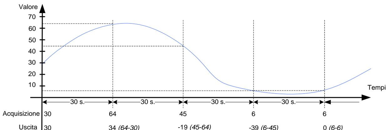
Il principio del calcolo della portata in modo tendenza si riferisce a quando il TwinY effettua un'acquisizione dell'ingresso analogico tutti gli x secondi configurati nella rubrica «Periodo». Ad ogni acquisizione calcola la tendenza tra il valore precedente e il nuovo valore acquisito, cioè la differenza tra il nuovo valore e il valore precedente. Il valore risultante può essere sia positivo che negativo.
