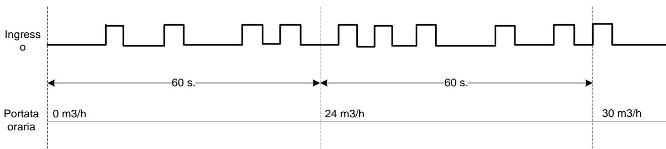
Il principio del calcolo della portata in modo frequenza, è di contare il numero d'impulsi durante un dato periodo. Alla fine di questo periodo, il calcolo della portata viene effettuato dando agli impulsi il peso del coefficiente.
