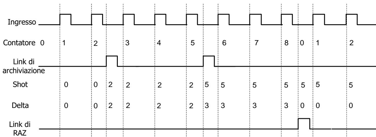
Ogni impulso incrementa il contatore del valore del coefficiente. Nell'esempio il coefficiente ha per valore 1. All'impulso del link di archiviazione, il valore del contatore è memorizzato nella variabile «Shot», e viene realizzato il calcolo del «Delta». Questo calcolo corrisponde al valore precedente di «Shot» meno il valore del contatore.
