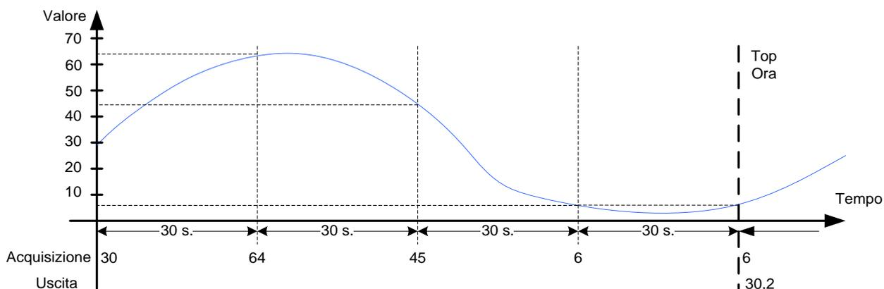
Il principio del calcolo della portata in modo medio si riferisce a quanto il TwinY effettua un'acquisizione dell'ingresso analogico tutti gli x secondi configurati nella rubrica «Periodo». Alla fine di un'ora, calcola la media dell'insieme dei campionamenti acquisiti. Il valore visualizzato è aggiornato tutte le ore ad orario fisso.
