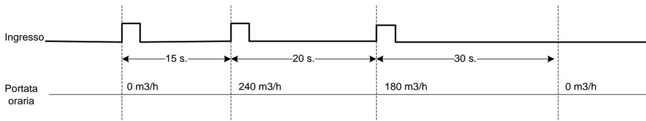
Il principio del calcolo della portata in modo periodo, è di misurare il tempo tra due impulsi al fine di determinarne la portata. Per questo calcolo, il TwinY ha come base di tempo il secondo, essendo il risultato una portata/secondo, è sufficiente calibrare il coefficiente moltiplicatore per ottenere una portata oraria. Il valore del campo «Periodo» corrisponde all'intervallo alla fine del quale, in assenza di impulso, il TwinY considera che la portata è nulla.
